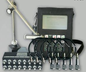
Ассоциация ВАСТ представляет полный спектр комплексов для балансировки роторов в собственных опорах на базе виброанализатора СД-12М - от малых систем для балансировки машин, имеющих до 3 плоскостей установки масс и до 8 точек контроля вибрации, до профессиональных систем, практически не имеющих ограничений.
