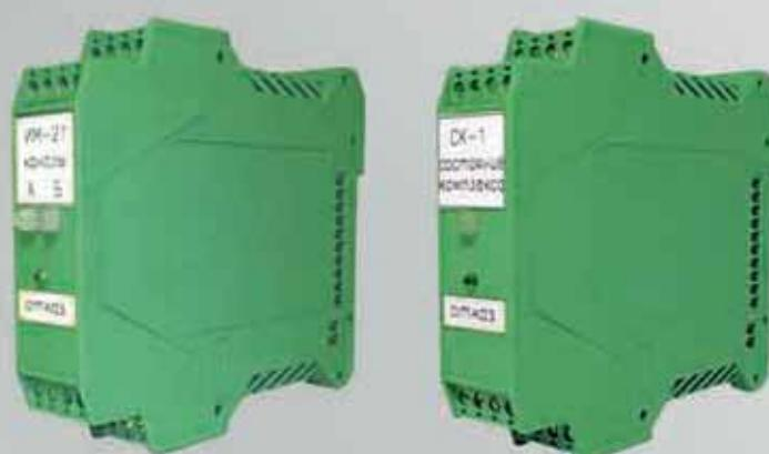
ИМ-21 содержит два канала, соответствующие двум каналам ВМ-21 и обеспечивает релейную сигнализацию, преобразование значений вибропараметров в постоянный ток 4-20 mA. Также ИМ-21 формирует сигналы для засветки мнемосхемы
