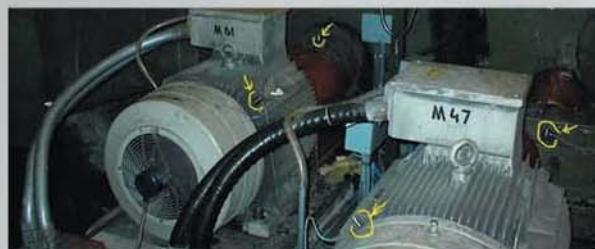
На фотографиях показан монтаж вибропреобразователей стационарной системы на проволочном стане. Слева и справа - на подшипниках главного привода, сверху на подшипниковых щитах двигателей приводов.
